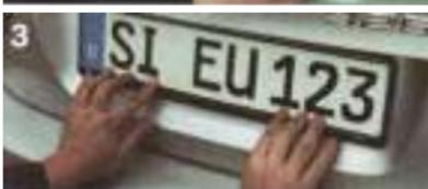
3. Drücken Sie das Kennzeichen nun flach auf die Grundplatte und schieben Sie das Schild unter den oberen Rand bis es hörbar einrastet. Der schwarz eingefärbte Rand des Schildes ist nun größtenteils von Rand der Grundplatte verdeckt.
