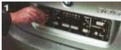
1. Wählen Sie das zum auszurüstenden Fahrzeug passende Lochbild und befestigen Sie die Grundplatte mit den für Ihr Fahrzeug geeigneten Schrauben.
